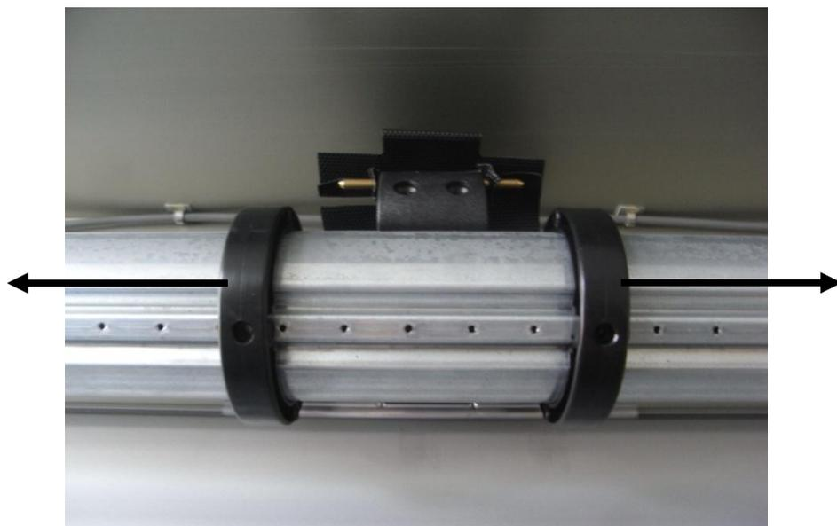
6- Dévissez les 2 vis sur l'axe côté stop chute.
