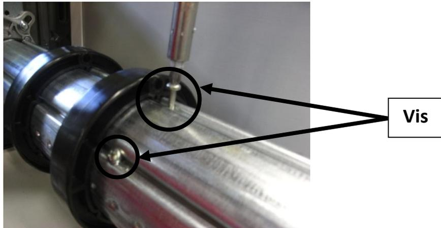
7- Dévissez la fixation de liaison sur le carré entre l'axe et le stop chute.
