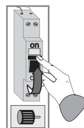
1 : coupez l'alimentation au tableau électrique, 1 seconde mini (fuseable ou disjoncteur).
