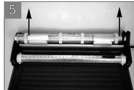
Otez le rivet de blocage du moteur (ne pas enlever les rivets du VA).
